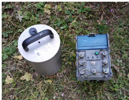
Φορητός Σεισμογράφος και Σεισμόμετρο
