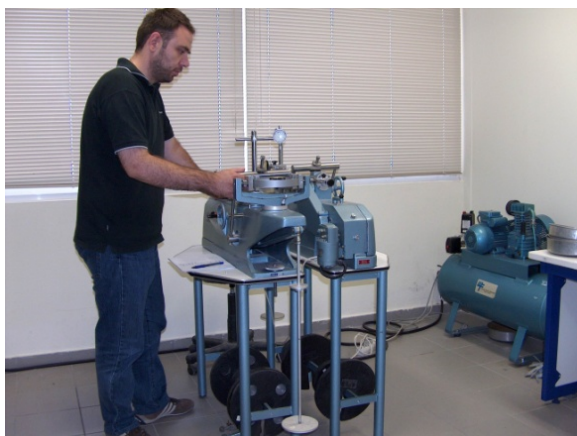
Συσκευές διάτμησης εδαφών
