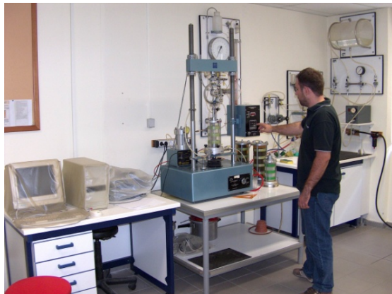
Συσκευή τριαξονικής φόρτισης για εδάφη
