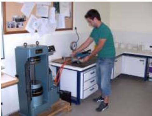
Συσκευή τριαξονικής φόρτισης για βράχους
