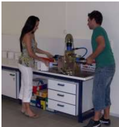
Συσκευή διάτμησης ασυνεχειών βράχων
