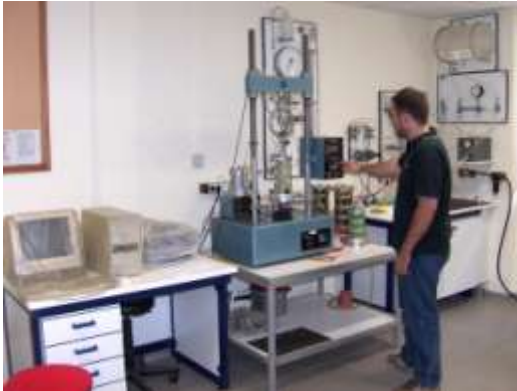
Συσκευή τριαξονικής φόρτισης για εδάφη
