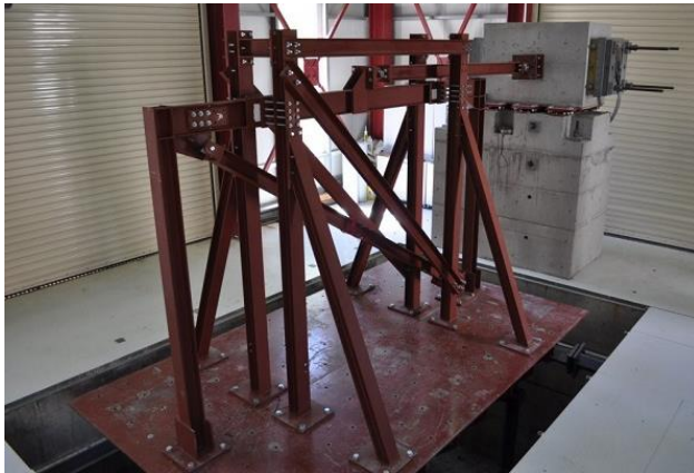
Δοκιμή μεταλλικού πλαισίου με ειδικό αποσβεστήρα στη διαγώνιο
