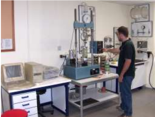
Συσκευή τριαξονικής φόρτισης για εδάφη
