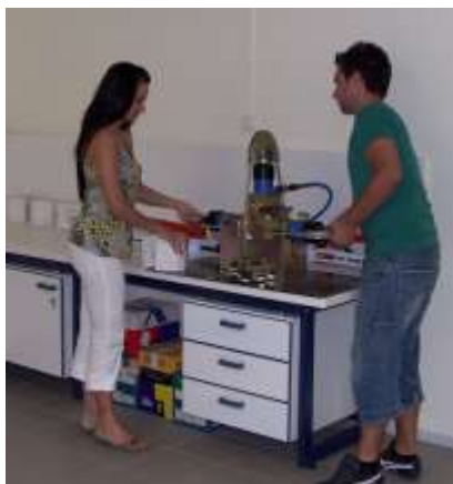
Συσκευή διάτμησης ασυνεχειών βράχων
