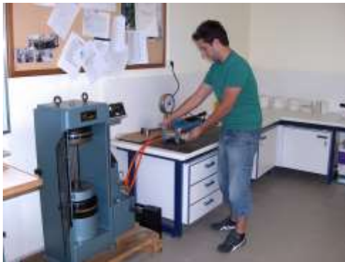
Συσκευή τριαξονικής φόρτισης για βράχους
