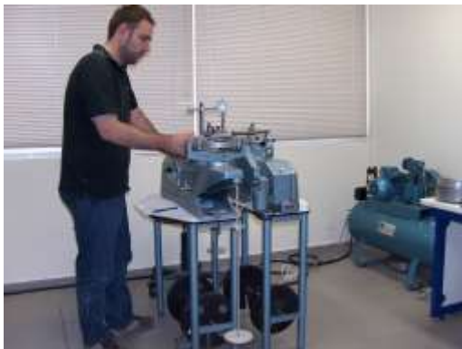
Συσκευές διάτμησης εδαφών
