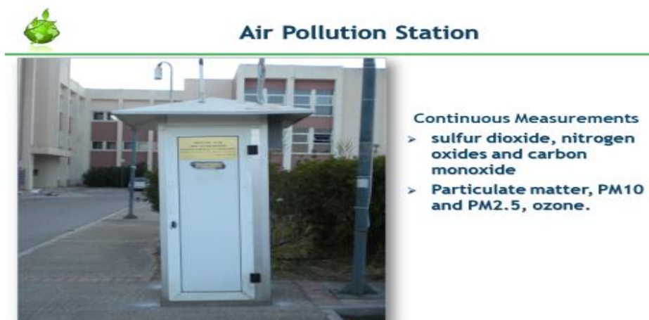
Εικόνα: Σταθμός Ελέγχου Ατμοσφαιρικής Ρύπανσης
